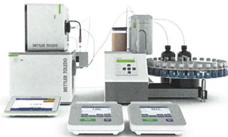
**Bild 3:** Messsystem, bestehend aus einem Probenwechsler, einem Dichtemessgerät, einer Brechungsindexzelle, einem pH-Meter und einem Leitfähigkeitsmessgerät. (Für Dichte und Brechungsindex zeigt das Bild vergleichbare aktuelle Systeme).
